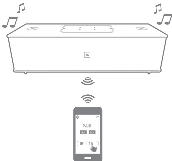
Se o sistema estiver em modo Standby (Espera) ou em Sleep (Suspensão), o sistema entra em modo Operacional (Operacional) após tocar com um telemóvel.
